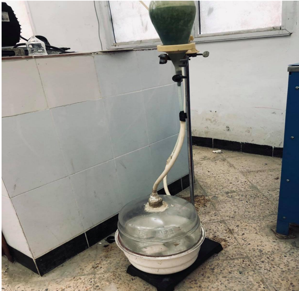
Figure 2.17 : Dispositif de saturation sous vide des éprouvettes.
