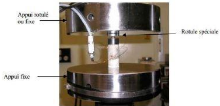
Figure 1.8 : Essai de compression simple avec les jauges de déformation. [37]
