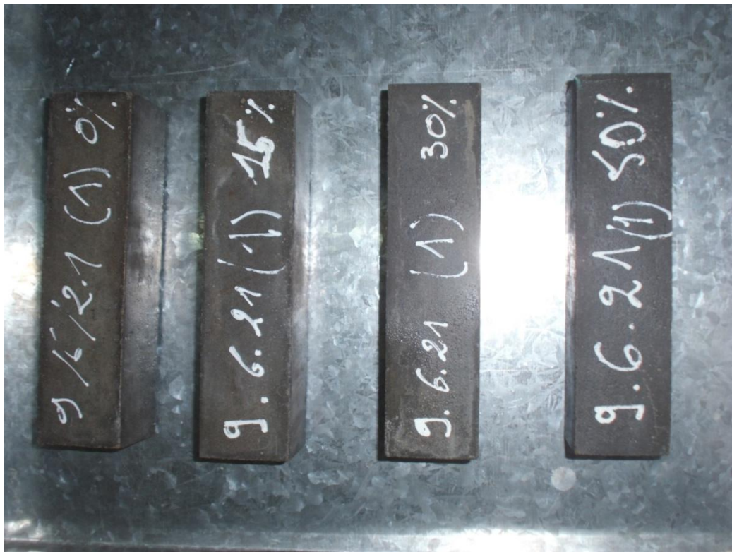
Figure 2.12: Des éprouvettes 4 \times 4 \times 16 \text{ cm}^3 .
