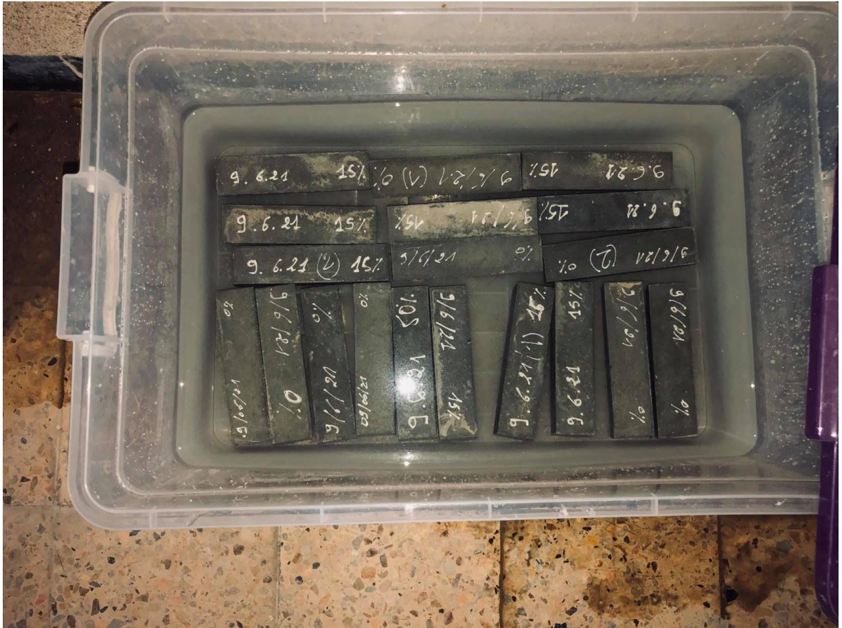
Figure 2.18 : Immersion totale des échantillons de l'eau dosée à 5 % de \text{Na}_2\text{SO}_4 .
