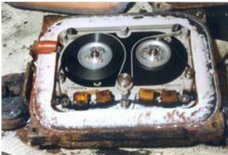
Figure III - 5: Intérieur d'un enregistreur magnétique
