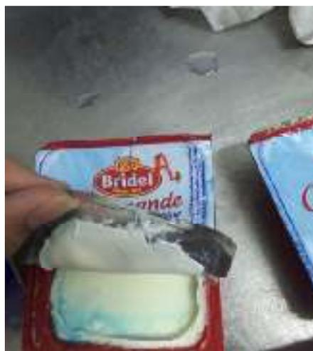
**Figure 20:**Résultats du test d' étanchéité d'emballage.
