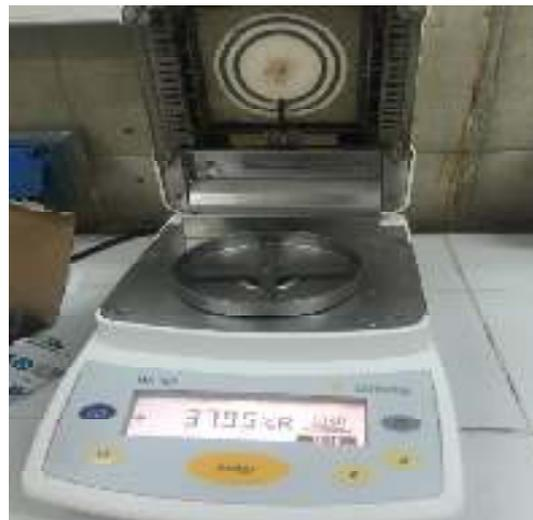
Figure 12: Détermination de l'EST par MA150.
