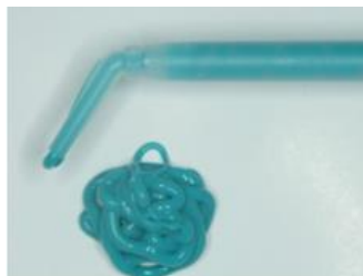
Figure 1 : la viscosité du matériau conditionne son aptitude à l'étalement
