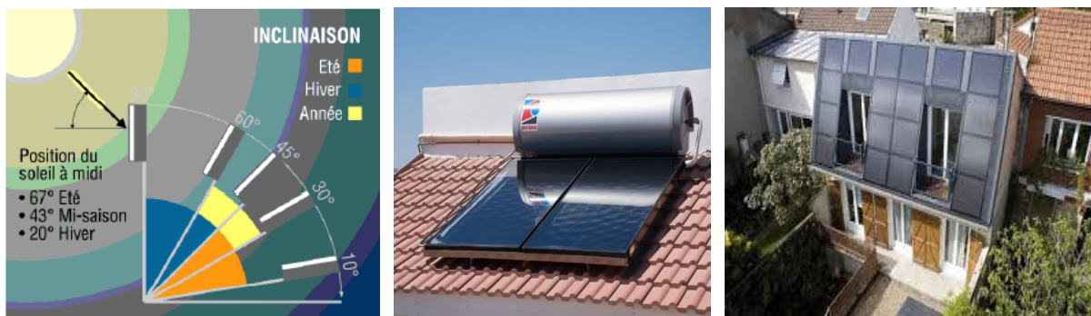
Figure 38 L'intégration idéal des capteurs solaires. [30]
