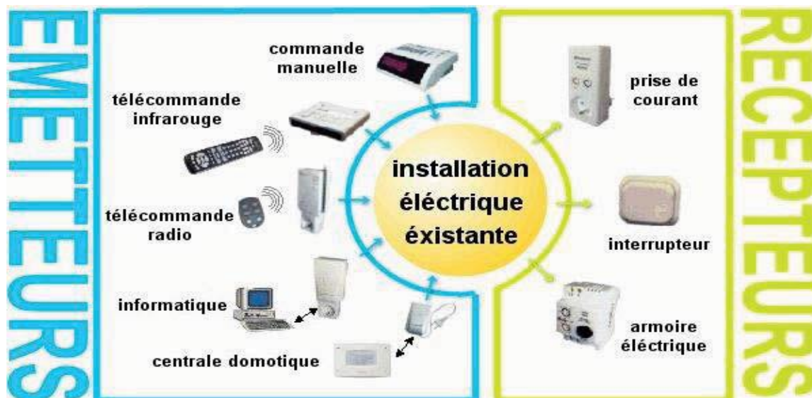
Figure 25 exemple d'une installation avec prise CPL. [17]
