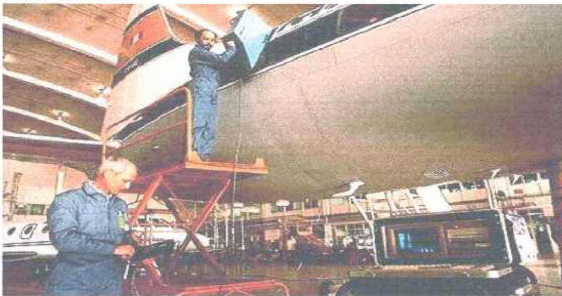
Figure. II. 1. Aéronef subissant une inspection non destructive
