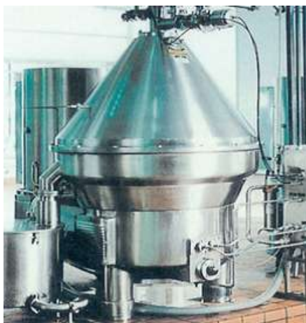
Figure 2 : Centrifugeuse utilisée pour l'écémage du lait (Boutonnier, 2007)
