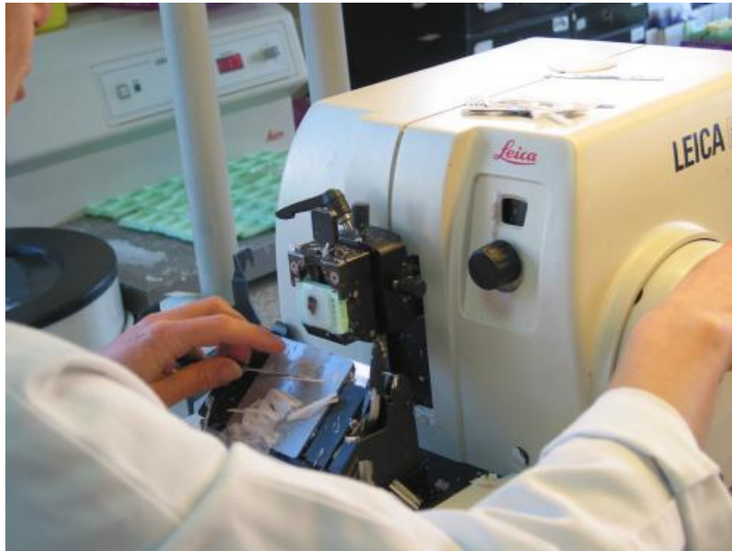
Figure11 : La coupe au microtome du bloc histologique : confection des lames histologiques. (15)
