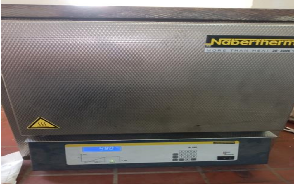
Figure III. 12 Le four (NABERTHERM) en mise en solution.
