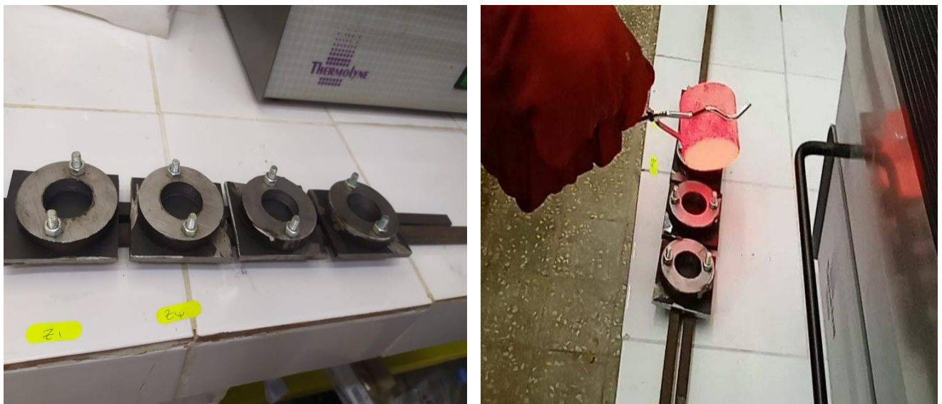
Figure III.3 le creuset en graphite utilisé et les moules a cylindre ouvert en acier.
