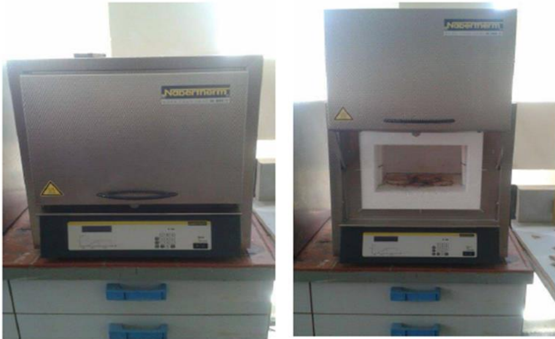
Figure III.2 Le four utilisé pour le traitement thermique NABERTHERM.
