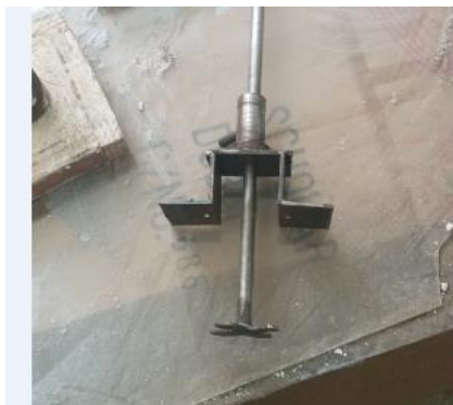
Figure V.4: Guide avec l'arbre et l'hélice de mélange.
