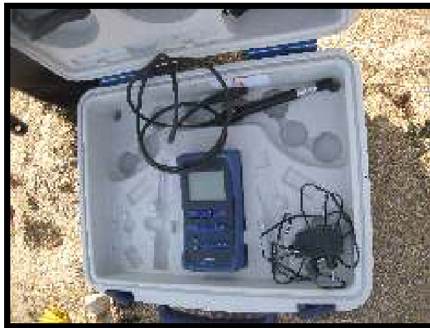
Figure 7 : Multi paramètres utilisé ( WTW 2F40-114BOE Meter Kit Multiparameter Handheld Model 34Di)
