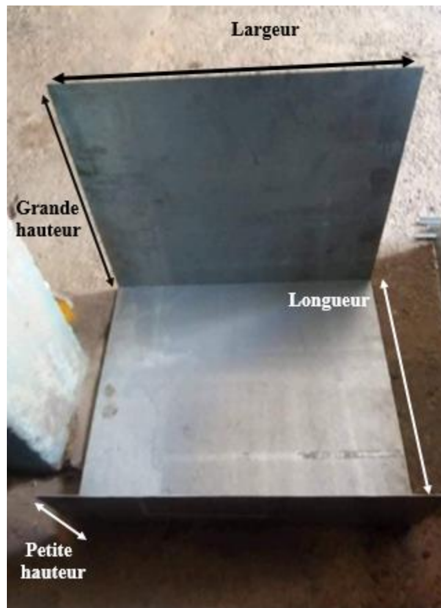
Figure III.16. Le bac couvrant de notre distillateur solaire à cascade
