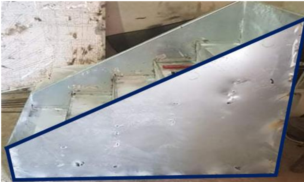
Figure III.15. Paroi d'un distillateur solaire à cascade
