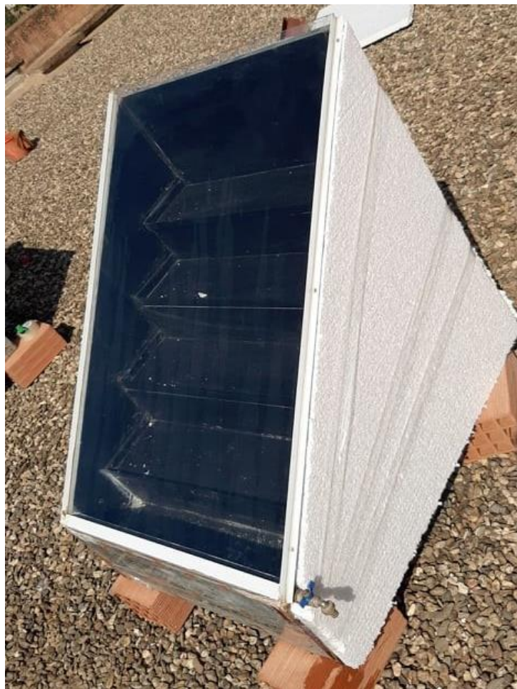
Figure III.18. Le polyptère collé sur les côtés du distillateur
