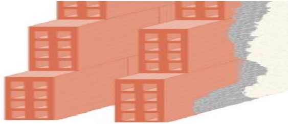
Figure II-4 Murs extérieurs (doubles cloisons).
