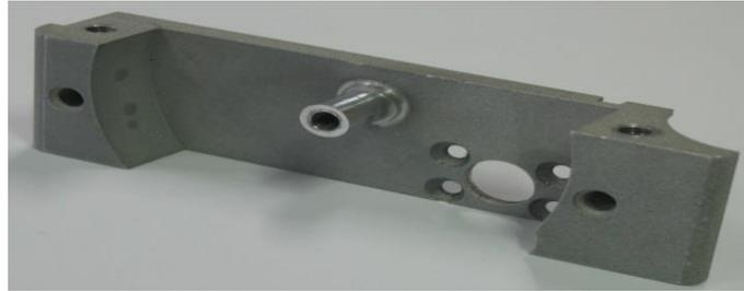
Figure 3 : Modèle « FAO » (pièce usinée) [2].
