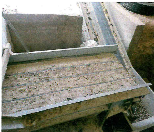
Tapis roulant retirant les fientes (Photo personnelle)
