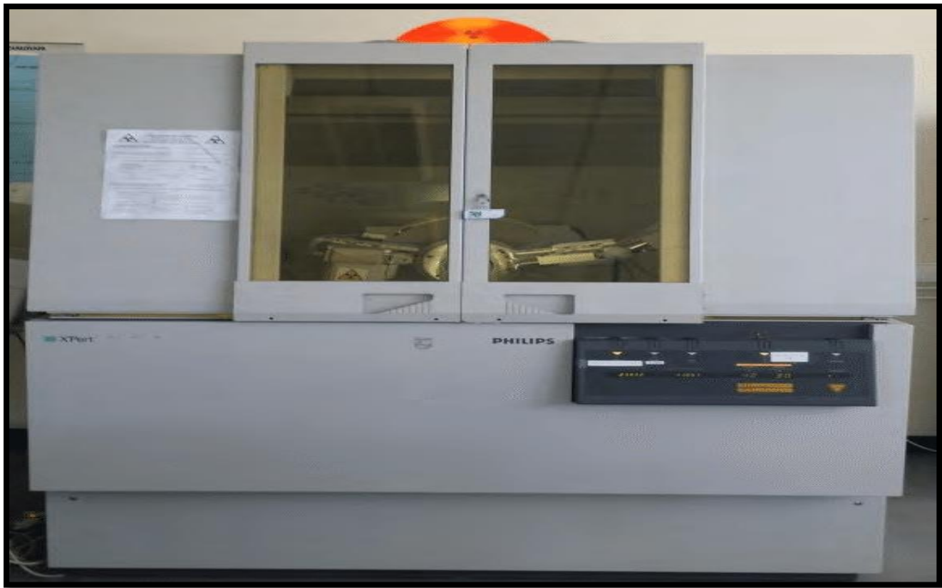
Figure.I.15. Diffractomètre utilisé pour la diffraction des rayons X
