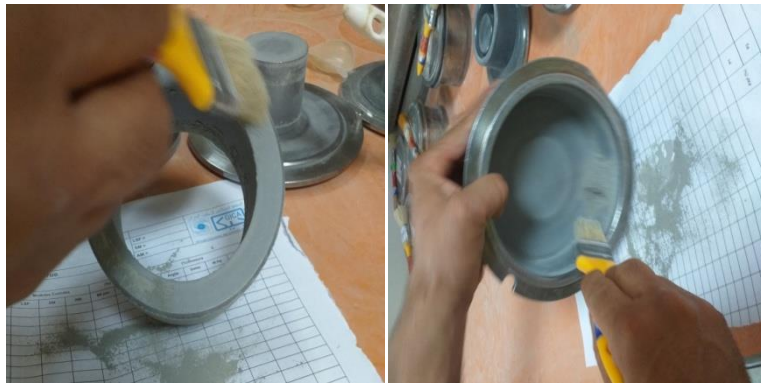
Figure 2.12 : Récupérer le ciment et cellulose broyée
