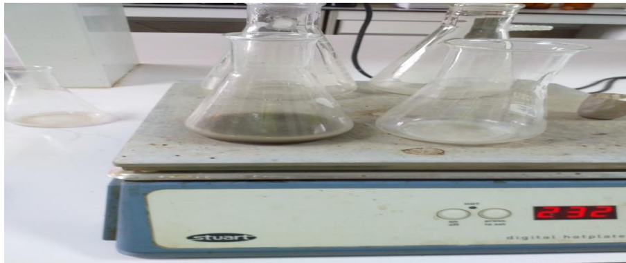
Figure 2.33 : Agiter fortement et mettre dans bain marie pour chauffage à T= 80\text{ }^{\circ}\text{C} .
