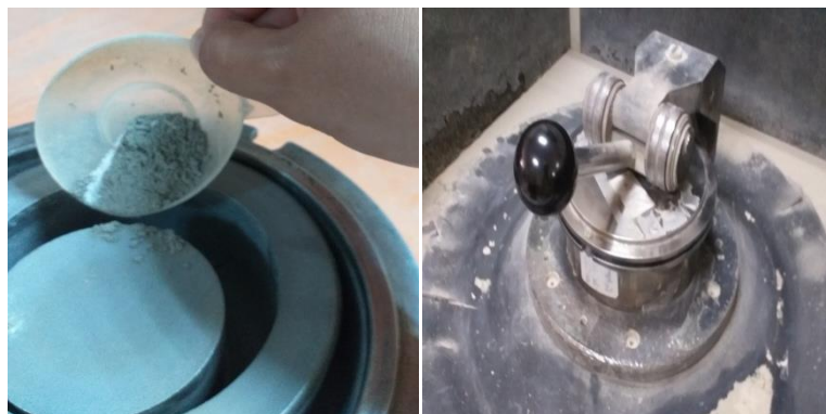
Figure 2.10 : Broyé le ciment et cellulose utilisation le broyeur HERZOG.
