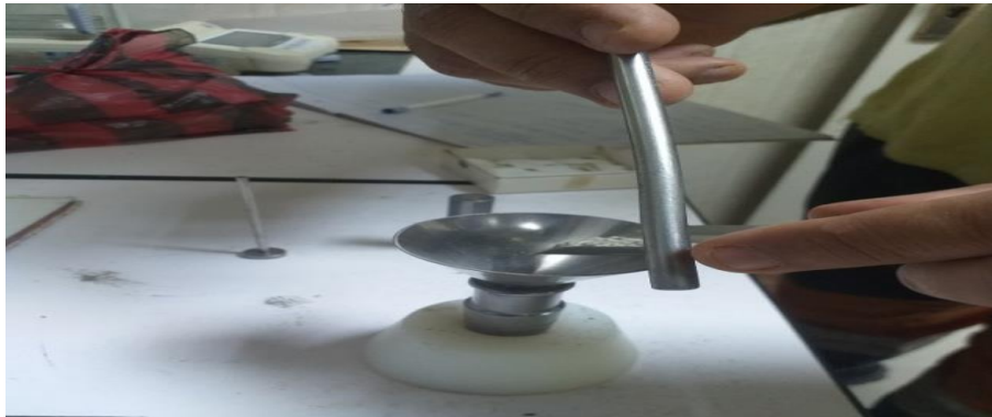
Figure 2.24 : Verser le ciment dans la cellule en utilisant un entonnoir.
