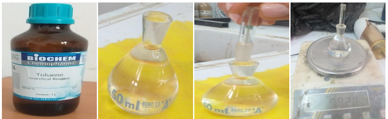
Figure 2.17 : Remplir le pycnomètre avec le toluène
