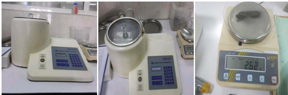
Figure 2.4: Matériel d'essai refus par tamisage ALPINE
