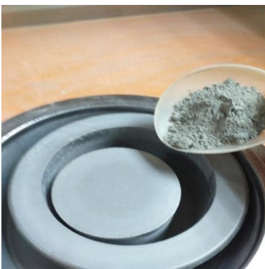
Figure 2.1: Verser le ciment dans le disque de broyage
