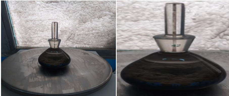
Figure 2.19: le pycnomètre +ciment+toluène
