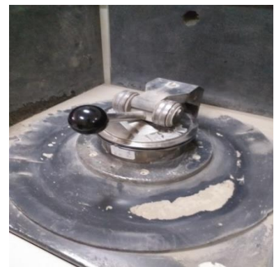
Figure 2.2 : Placé le disque dans le broyeur
