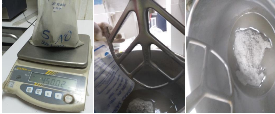
Figure 2.39 : 450 g de ciment et ajouté dans le récipient
