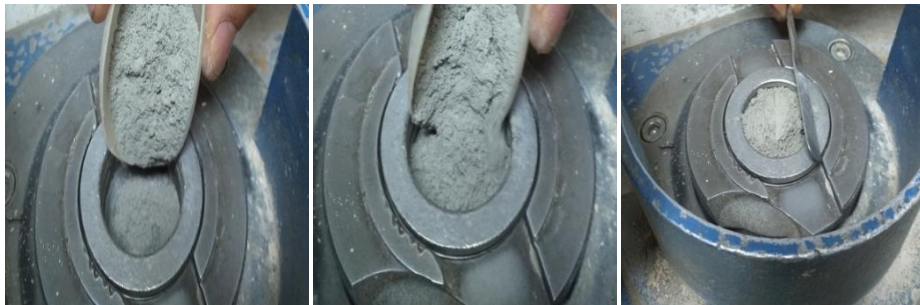
Figure 2.13 : Mettre l'anneau dans la pastilleuse et verser le ciment broyé dans cet anneau.
