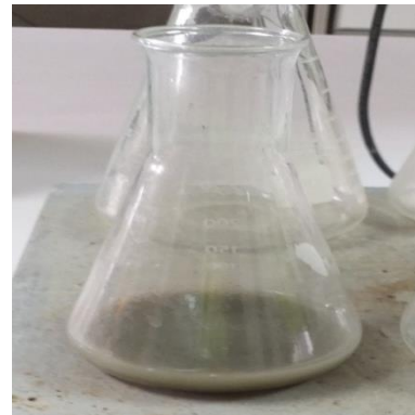
Figure 2.31 : Introduire le ciment pesé dans un Ellen Meyer de 250ml
