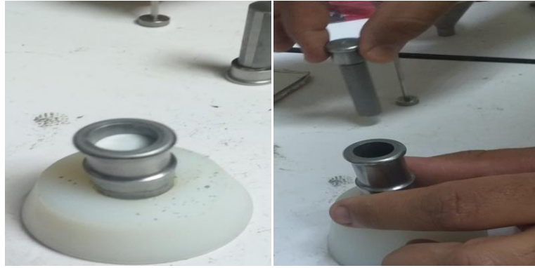
Figure 2.26 : Tasser avec précaution au moyen du piston
