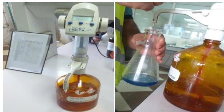
Figure 2.36 : Titrer le filtrat avec une solution de HCl 0.1 N en présence du bleu de bromocresol
