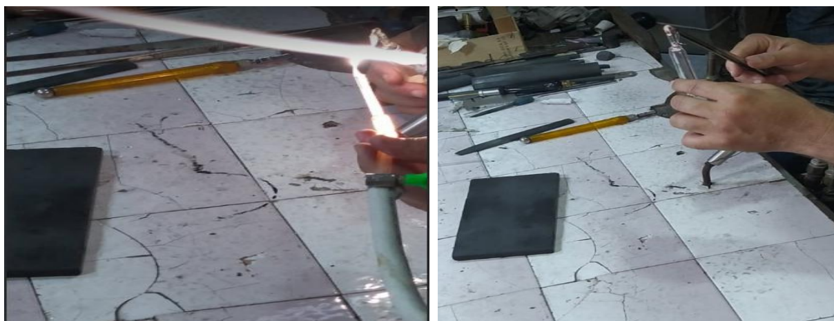
FIGURE 2.4 : (A) SCELLAGE DES TUBES, (B) COUPURE DU TUBE QUI EST LIEE PAR LA POMPE A VIDE ET FIN DU SCELLAGE.
