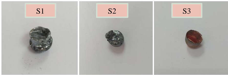
FIGURE 3.2 : LINGOTS OBTENUS APRES LA SYNTHESE
