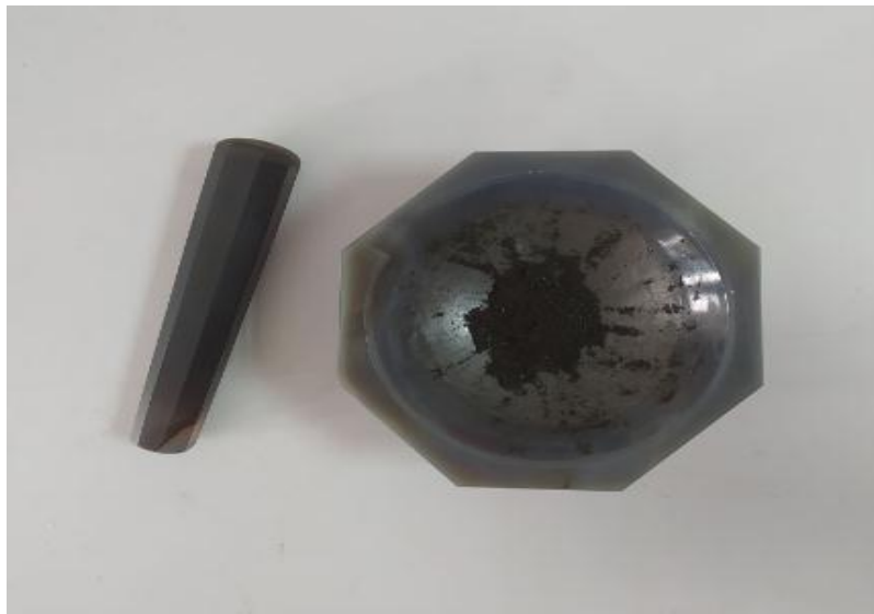
FIGURE 2.11 : MORTIER EN AGATE LABORATOIRE (CRTSE).
