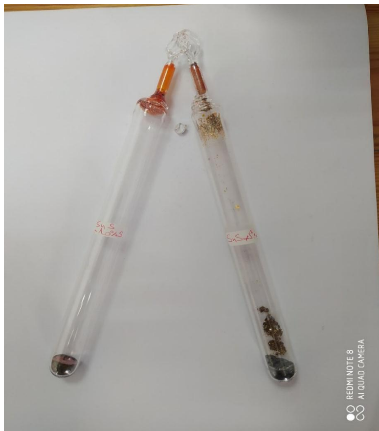
FIGURE 2.10 : LA SORTIE DES TUBES DANS LE FOUR TUBULAIRE.
