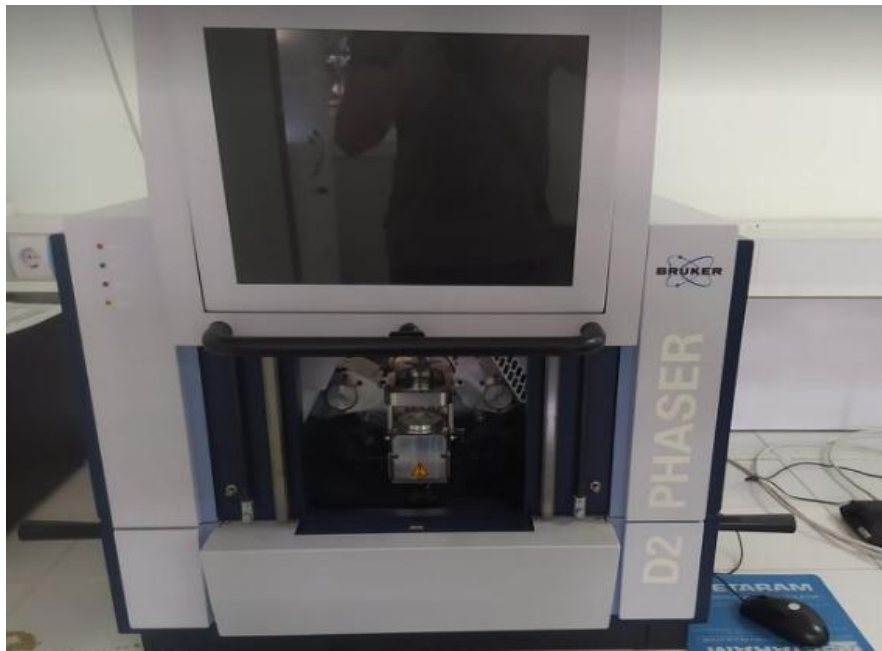
FIGURE 2.15 : DIFFRACTOMÈTRE BRUKER PHASER D2(LCPMM).
