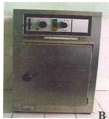
Photo 9 : A : le bain thermostaté, B : l'étuve.
