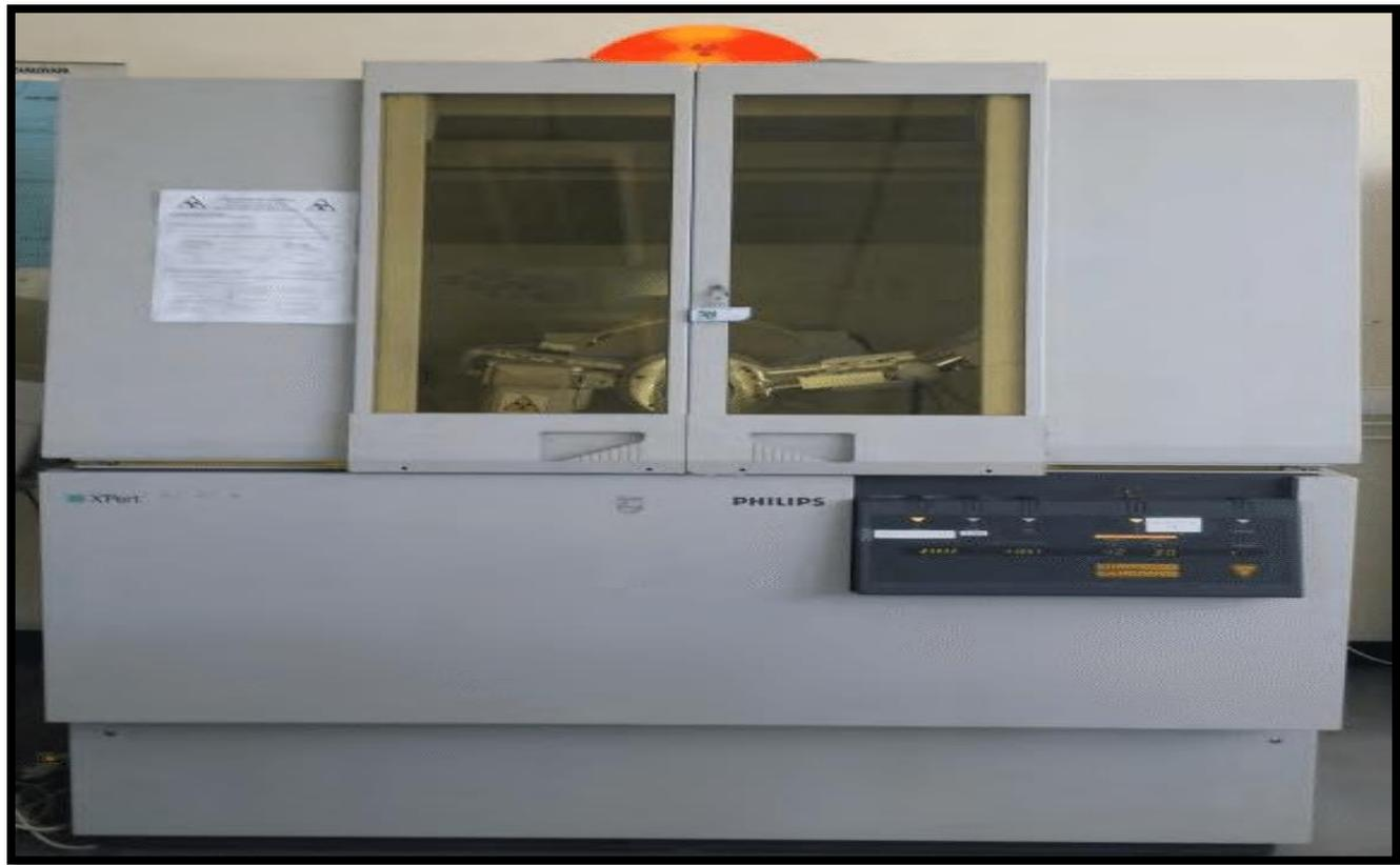
**Figure.I.15.** Diffractomètre utilisé pour la diffraction des rayons X
