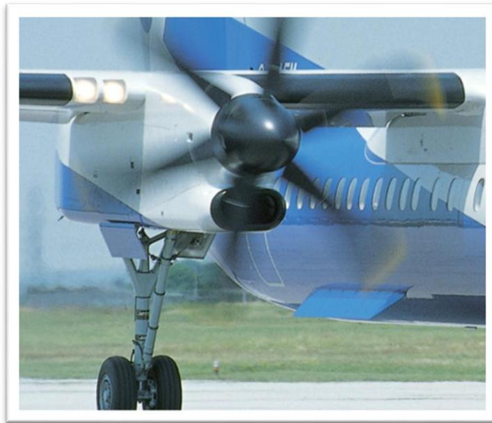
**Fig.II. 2: turbopropulseur de l'avion Q400 à 6 pales.**
