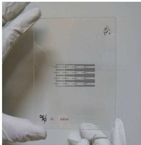
Fig 1.4 Masque photo lithographique sur substrat de verre avec chrome gravé
