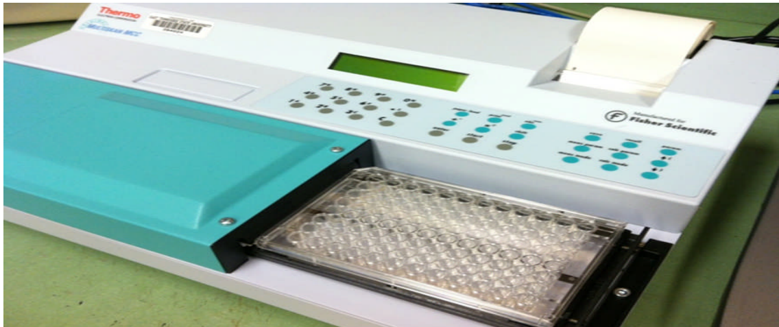
Figure 02: Lecteur ELISA « Thermo Scientific type Multiskan » à 450 nm utilisé lors du test sérologique.
