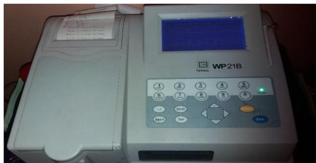
**Figure 8 :** Analyseur de biochimie semi-automatique WP 21B.
