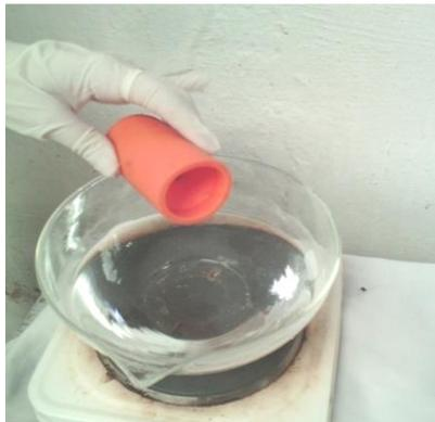
**Figure 31** : Plaque chauffante et le cristallisoir
