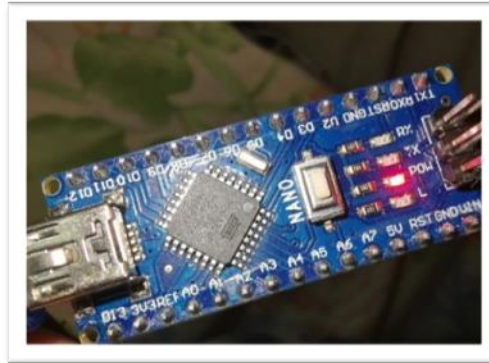
Figure (II- 0:9): carte Arduino Nano
