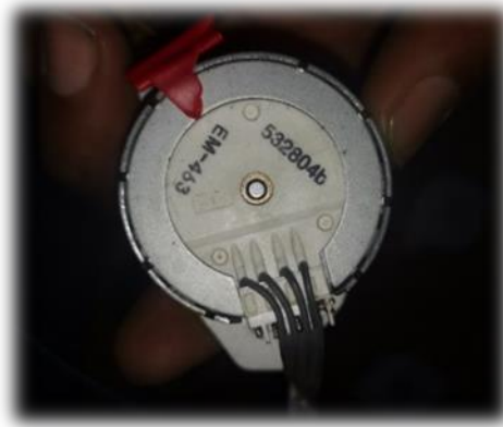
Figure (II- 0:8): Moteur pas à pas EM-463
