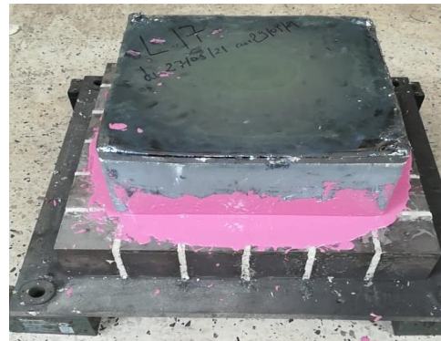
Figure (I. 9) : Lingot fixé par une résine avant le découpage.
