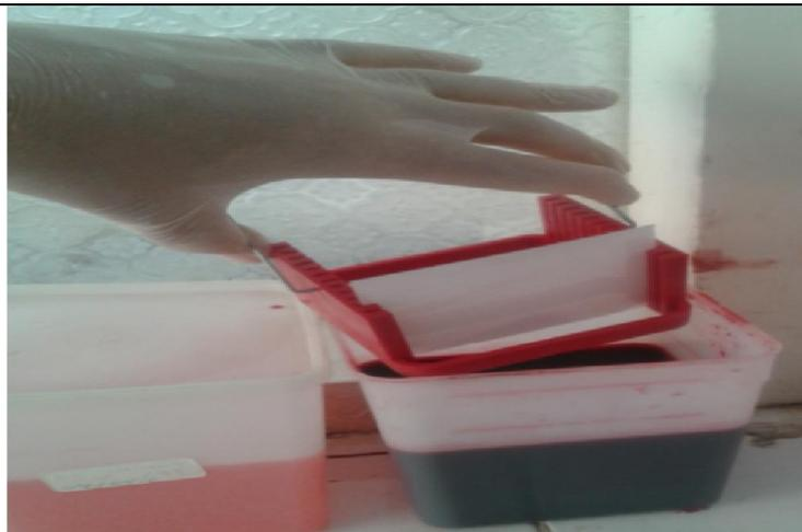
Figure 20 : coloration de la plaque d'acétate de cellulose
