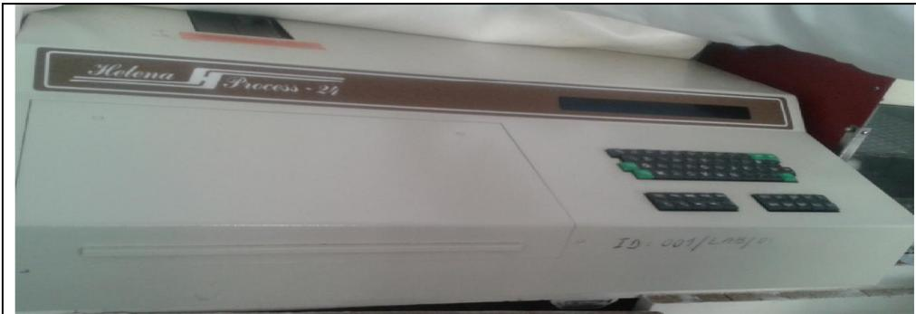
Figure 22 : Dosage des différentes fractions d'hémoglobine par le densitomètre.
