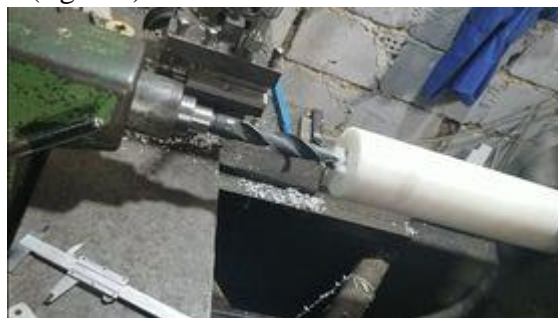
Figure 4.3. Perçage de vis sans fin.
