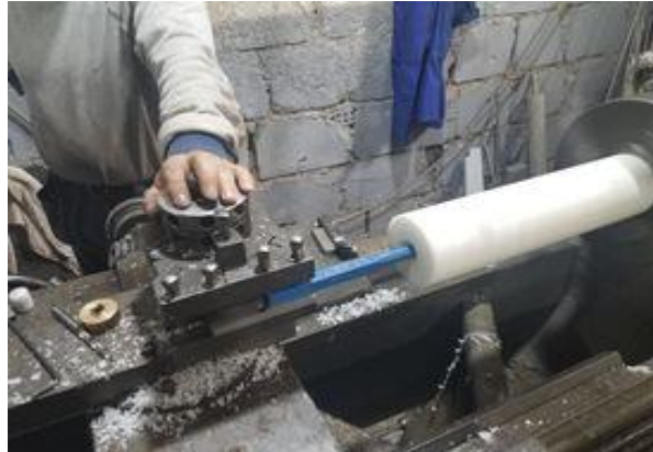
Figure 4.4. Alésage de vis sans fin
