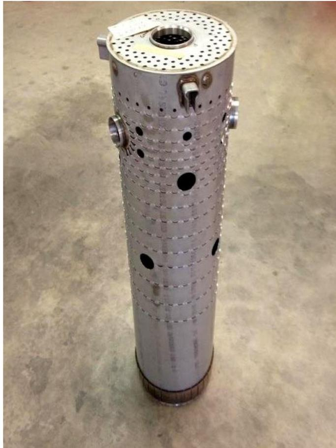
**Figure III- 1 : Tube à flamme LHE.**
