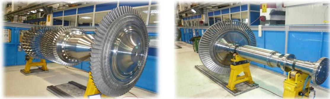
**Figure I- 22** : Schéma de rotor HP et rotor BP. [19]
