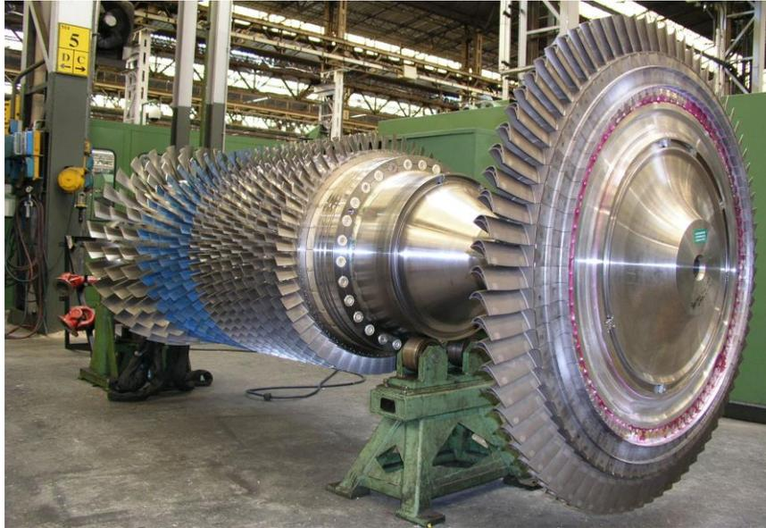
**Figure I- 14 :** Rotor du compresseur de la turbine à gaz MS5002b. [14]
