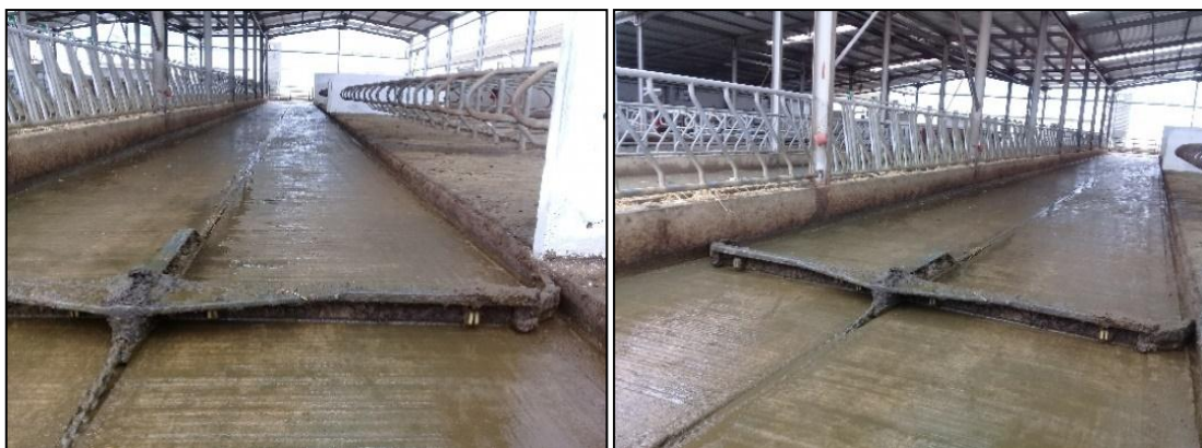
Figure 18: Raclage automatique au niveau de l'étable principale des vaches laitières – SPA AGRICOLE DOUMA – Décembre 2017 – (Photo personnelle)
