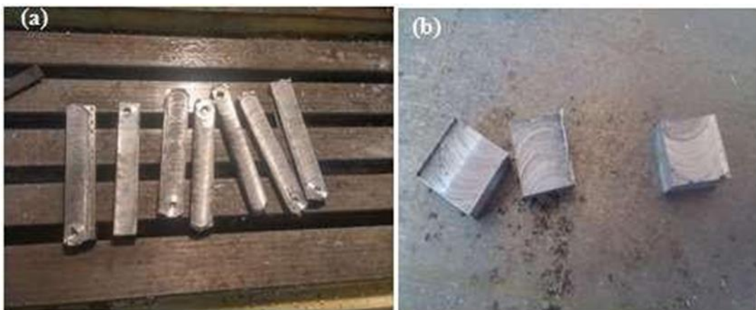
Figure III. 9 :a) les coupes des zones traitées. b) les coupes des échantillons.
