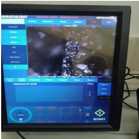
Figure IV.12 : imagerie de la surface de la phase MAX borurée de surface à l'extrémité avec la machine de micro dureté d'échantillon au 30% cuivre.
