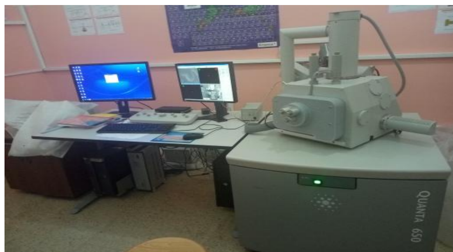
Figure III.2.1 : Microscope électroniques à balayage de type QUANRA650
