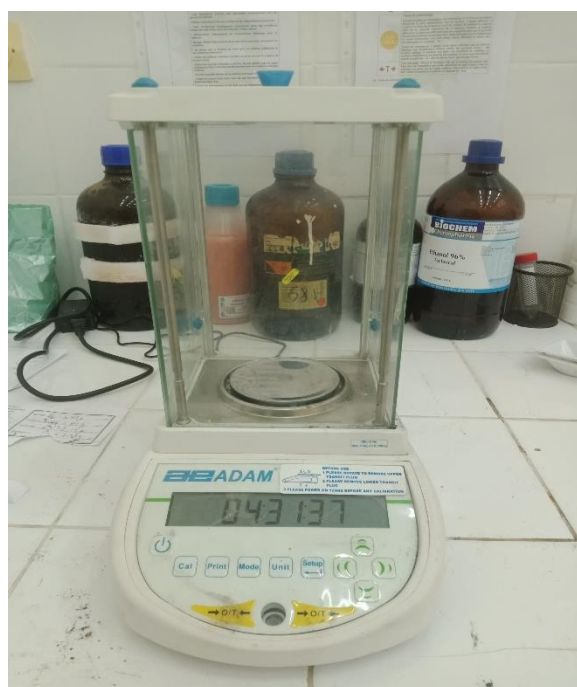
Figure III.1.1 : balance de précision de type Adam
