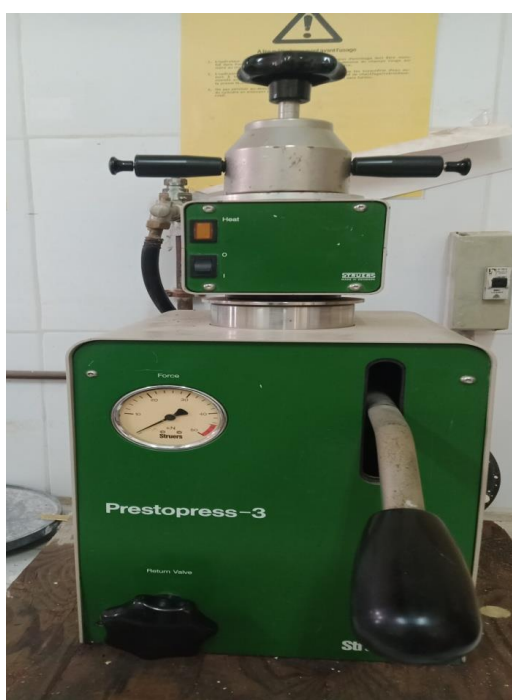
Figure III.1.5 : machine d'enrobage de type prestopress-3
