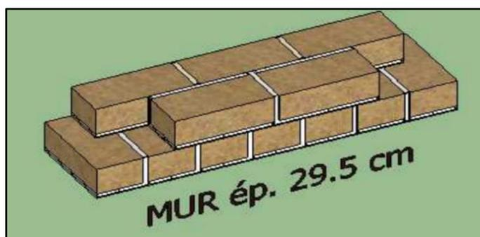
Figure 78 : Détail n°04, Appareillage mur en BTC Source :
