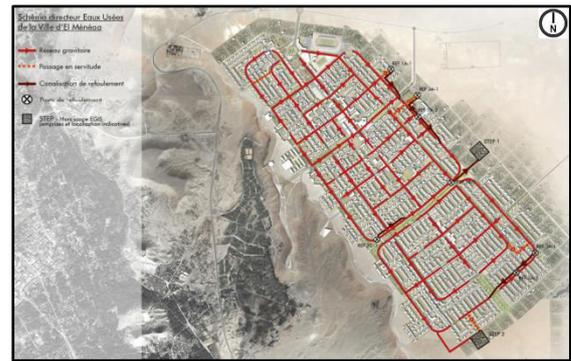
Figure 20 : Réseau d'assainissement de la ville nouvelle d'El-Ménéaa Source : Egis, 2012
