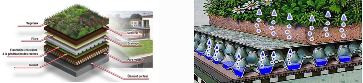
Figure 148: composants des toitures végétales .
