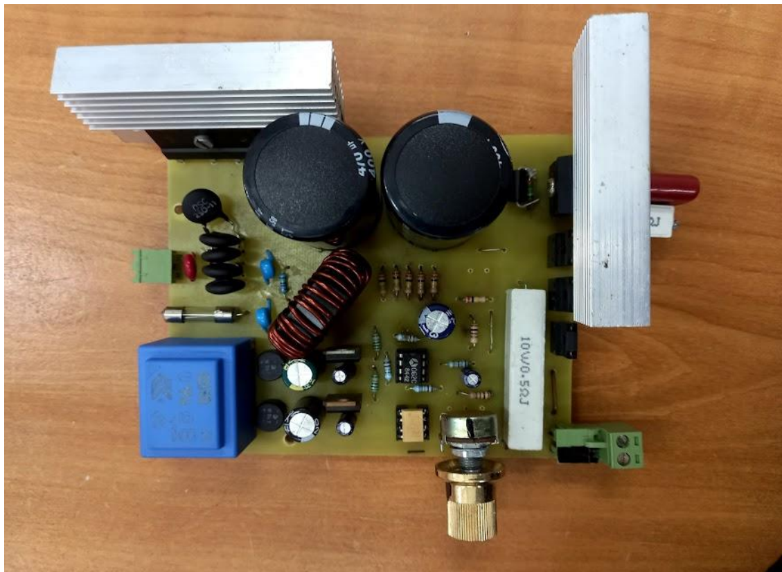
Figure 4.20 : Photo du circuit d'alimentation 320 V DC
