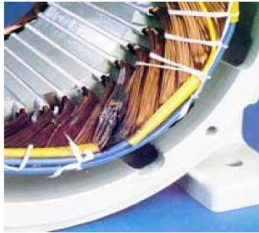
Dégradation causée par une surtension
