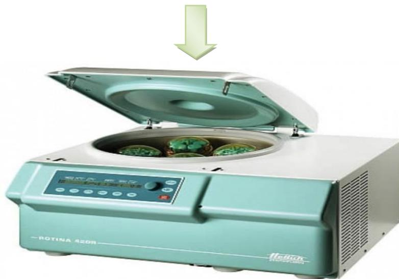
Figure 2.5 Centrifugeuse pour lavage d' HDL 5 a 6 fois .
