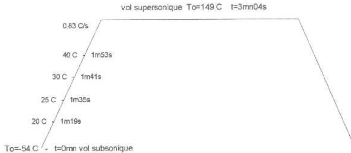
Fig.3.29 : cycle de température en vol supersonique
