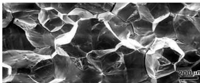
**Figure 123 : Faciès d'une fracture fragile inter-granulaire vu au MEB(90)**
