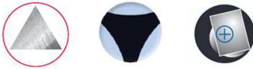
**Figure 131 : Figure 12: section des limes RaCe®, ProFile® et PorTaperNext® (111,112,113)**
