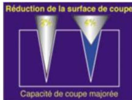
**Figure 38 : efficacité de coupe majorée par la réduction de surface de coupe**
