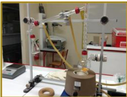
Protocole expérimental de l'hydrodistillation
