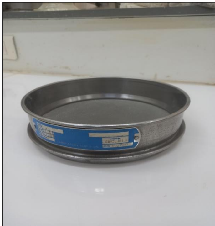
Figure 2.22 : Tamis 400 \mu m.
