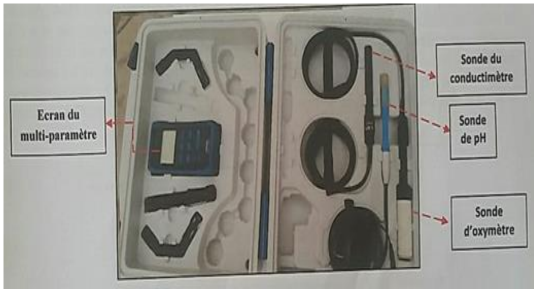
Fig.II.1 : analyseur multi-paramètres de type Multi 340i Set WTW (GOUICHICHE et BEDR, 2016).
