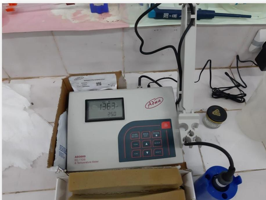
Figure 26 : Le conductimètre pour mesurer la conductivité (Photo original 2021).
