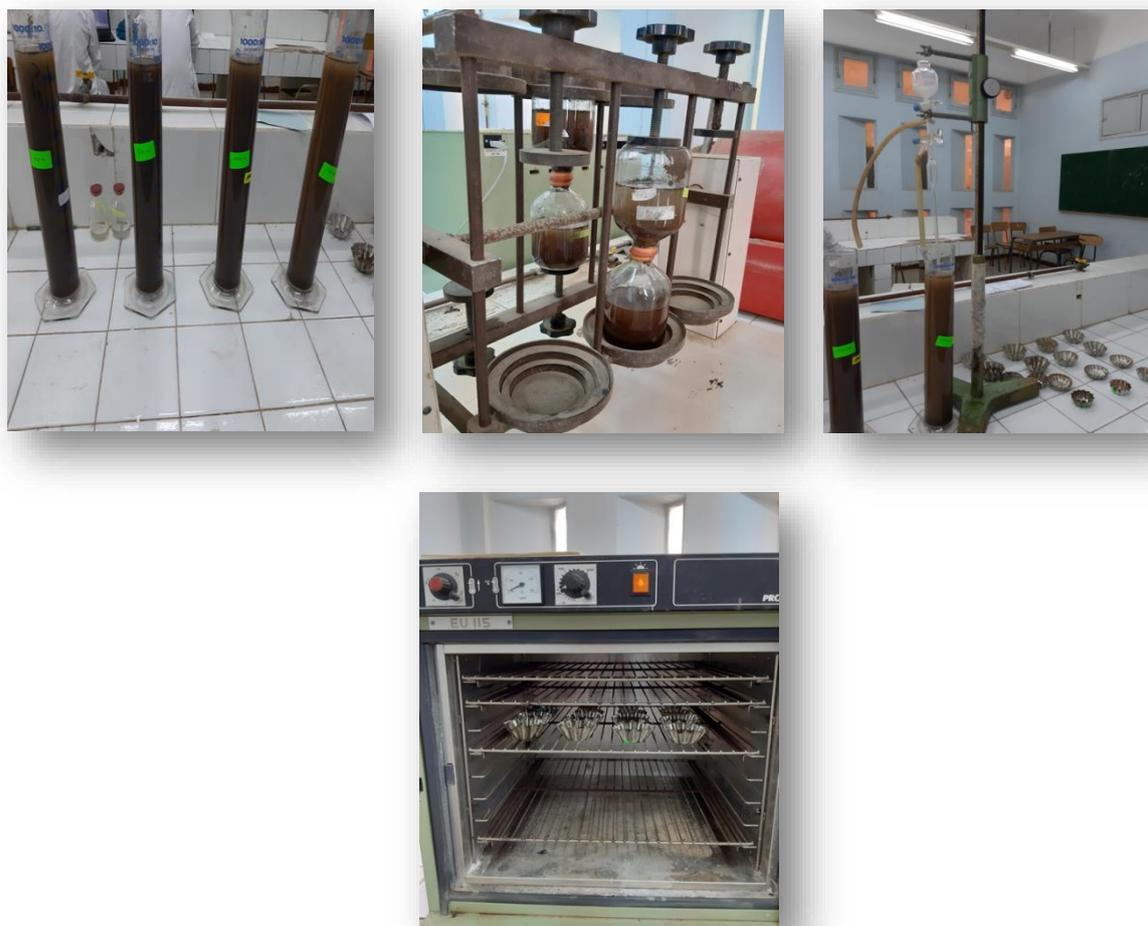
Figure 27 : Étapes de l'analyse granulométrique au laboratoire (Original 2021).
