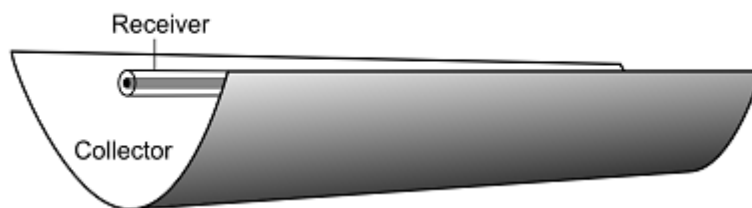
Figure 20: Le bac comprend à la fois un collecteur pour réfléchir l'irradiation et un récepteur absorbe et de transporte la chaleur
