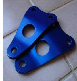
Exemples des pièces mécaniques anodisées et colorées par des colorants inorganiques
