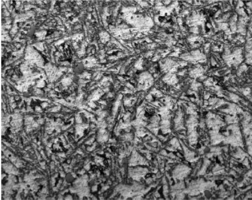
Figure (22) : microstructure d'échantillon Z1 grossissement X50 avant traitement thermique.
