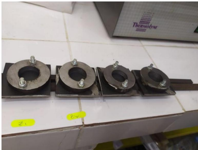
Figure (11) : le creuset en graphite utilisé et les moules a cylindre ouvert en acier.
