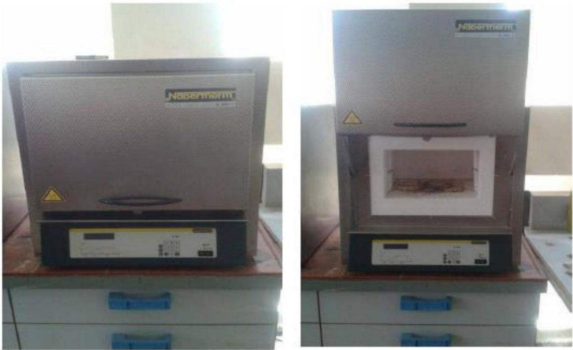
Figure (10) : Le four utilisé pour le traitement thermique NABERTHERM.
