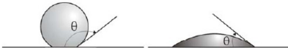
Figure 2.3 : Goutte de liquide sur une surface lisse - Définition de l'angle de mouillage.
