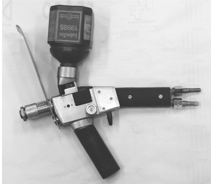
Figure 3.1 : Torche de projection thermique.
