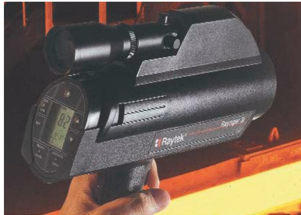
Figure 3.2 : Pyromètre Ranger.
