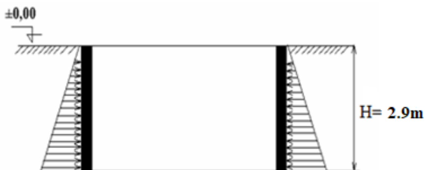
Figure.VI.16: Poussées des terres.
