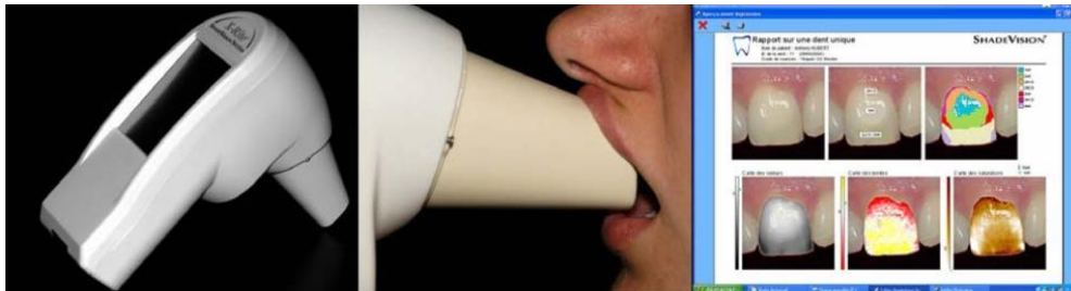
Figure 22 : Le colorimètre Sgade Vision de X Riteet la fiche de rapport d'analyse destinée au laboratoire [90]
